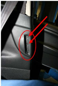
Abdeckkappe entfernen und die beiden Torxschrauben entfernen
