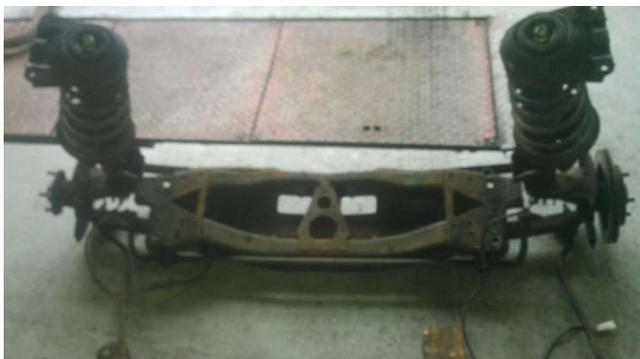
Hinweis: Beim Absenken des Hinterachsträgers werden die Stoßdämpfer durch die Handbremsseile und die Bremsschläuche gefädelt. Auf eine zugfreie Befestigung der Bremssättel zur Vermeidung von Schäden an den Bremsschläuchen ist zu achten.
