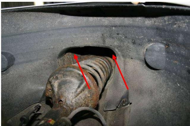
**Hinweis:** Die Domlager der Hinterachse sind beim Cougar von unten verschraubt.
