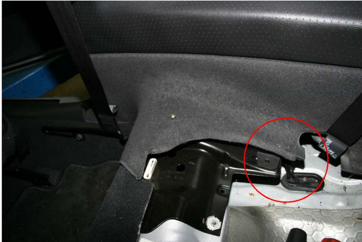
Die beiden Steckverbindungen befinden sich jeweils hinter der rechten und linken Seitenverkleidung (weißer Stecker)
