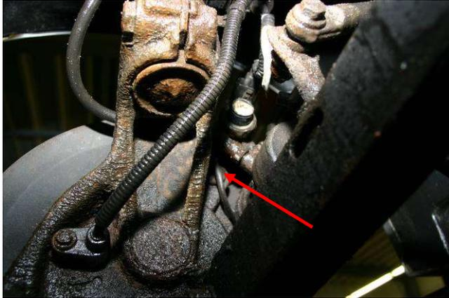
e. Bremssattel von der Scheibe komplett abziehen
