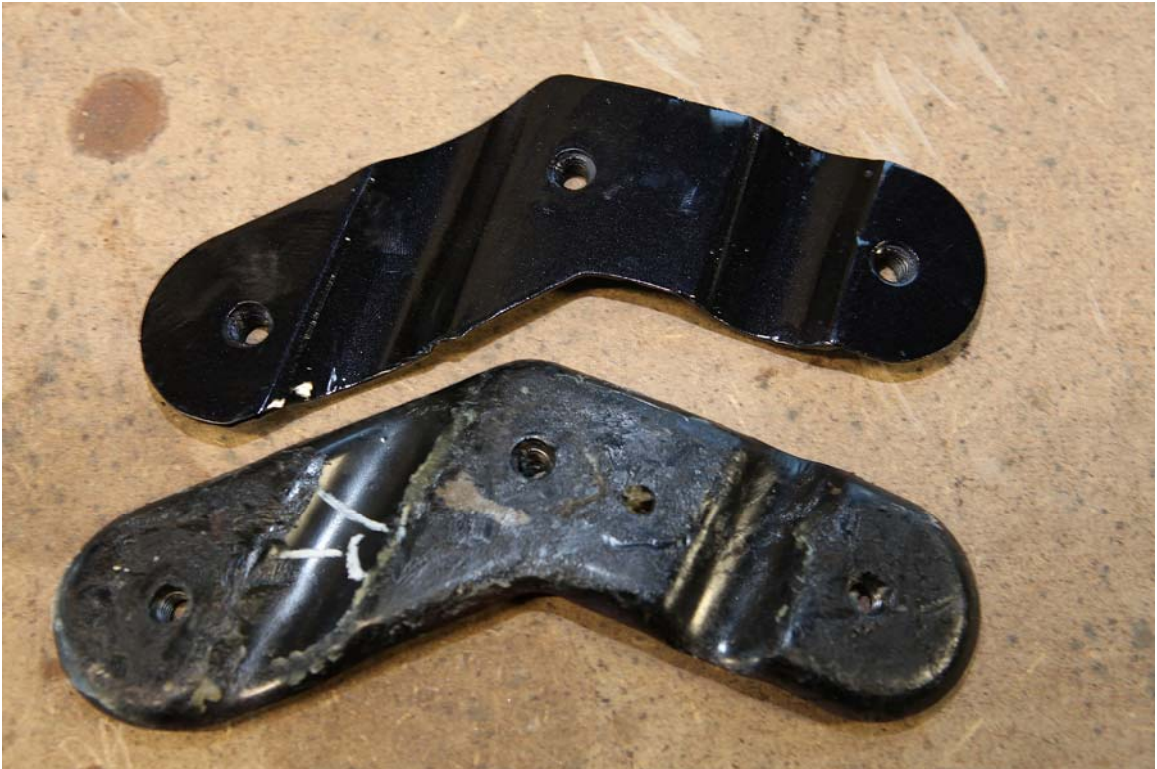
Verstärkungsblech an der Seiten Außen
