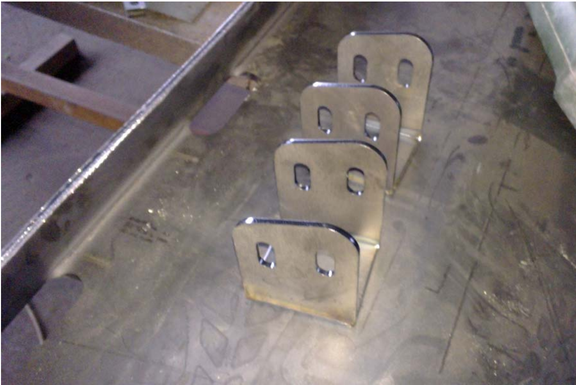
Die Haltebleche für die Diagonalstreben werden vorbereitet und angeheftet:
