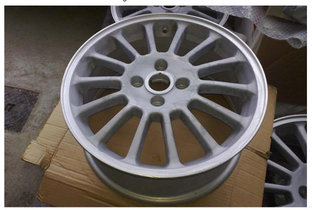
Nach dem Abbeizen wurden die Felgen in anthrazit-metallic lackiert und in die CNC-Drehmaschine eingespannt:
