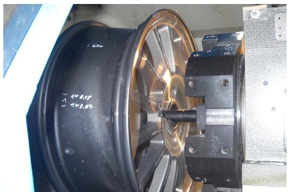
Nun erfolgt eine Spanabhebung in 2 Programmen. Eines wurde für das Felgenbett genommen und eines für den Felgenstern. Da die Speichen bei der Mondeofelge eine Wölbung aufweisen, wurden die Speichen in einzelnen 1/10 mm Schritten jeweils angefast (also 1/10mm x 10 x14 Speichen x 4 Felgen = 560 mal) und insgesamt 1 mm plangedreht.
