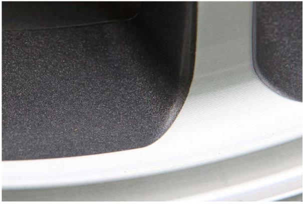
Grunddesign der 14-Speichen-Räder ist das der Mondeo ST200 – Felgen, jedoch mit ein paar Änderungen. Am auffälligsten ist der anthrazit-metallic Lack im Inneren und die glanzgedrehte Obenfläche mit den erkennbaren Riefen. Diese sind jedoch nicht erfühlbar, da die Oberfläche mit Klarlack überzogen ist. Auch treten die Kanten der Speichen durch das Abdrehen der Oberfläche wesentlich stärker hervor.
